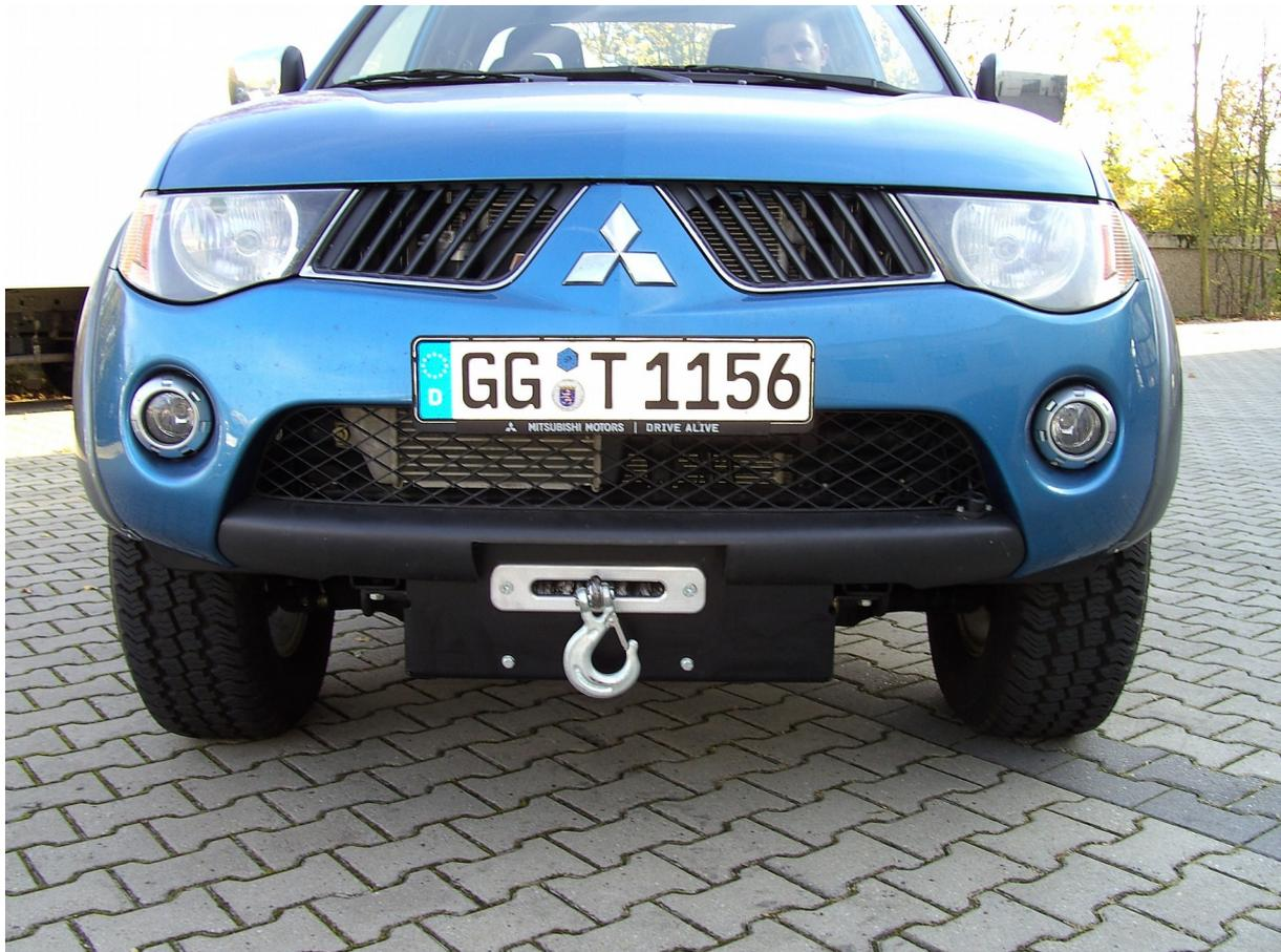
**Hier sehen sie den fertig montierten Seilwindenanbausatz.
